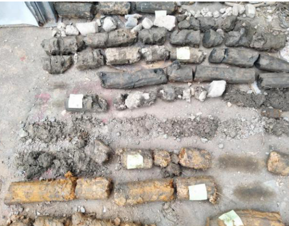
图4 旋喷桩加固后取芯示意图
