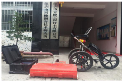
图4 SIR-20地质雷达工作车载模式
