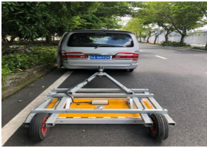
图5 GeoScope三维探地雷工作达车载模式
